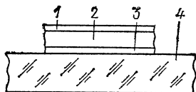
Рис. 32. Разрез структуры голограммы на термопластике: 1 — слой термопластика, 2 — слой полупроводника, 3 — проводящий слой, 4 — стеклянная основа.
